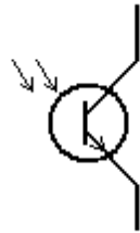
Fig. 2.1.13 El Fototransistor, simbología y encapsulado
