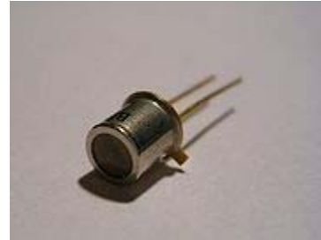
Fig. 2.1.13 El Fototransistor, simbología y encapsulado
