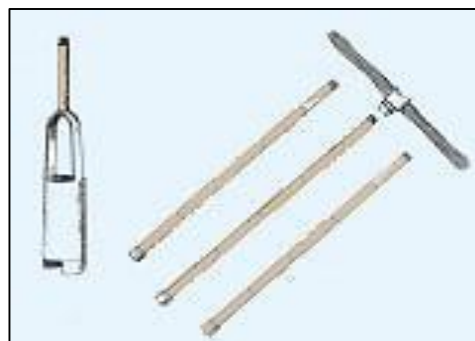
Figura 2.25. Barrena Hueca. Fuente: Braja M. Das
