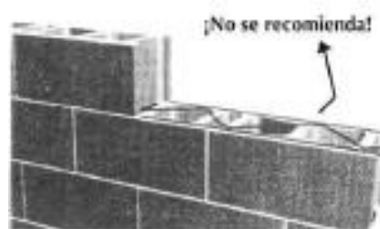
Figura 6.7 Refuerzo de armadura diagonal.
