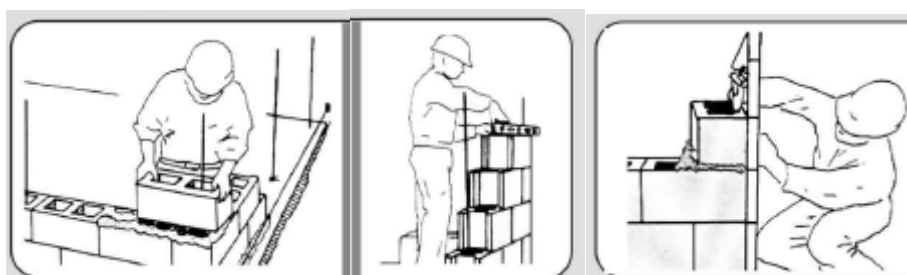
Figura 6.3 Elevación de hiladas en las esquinas. Verificación de horizontalidad superior. Verificación de ubicación en altura.
