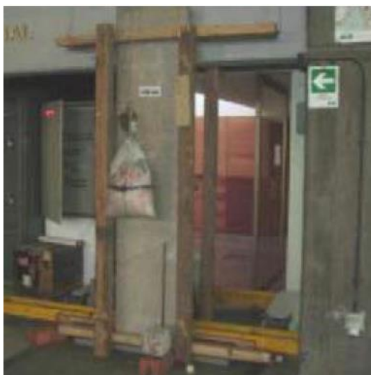
Figura 4.7: DICTUC. Ensayo de carga de impacto Fuente: (Carrasco, 2010).
