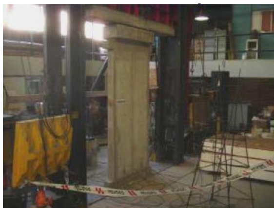
Figura 4.4: DICTUC. Ensayo de carga vertical (compresión) Fuente: (Carrasco, 2010).
