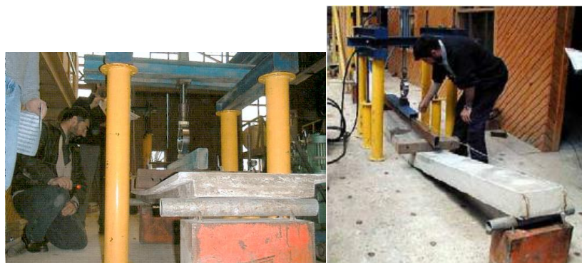
Figura 4.6: DICTUC. Ensayo del panel, ensayo a flexión de losa Fuente: (Carrasco, 2010)
