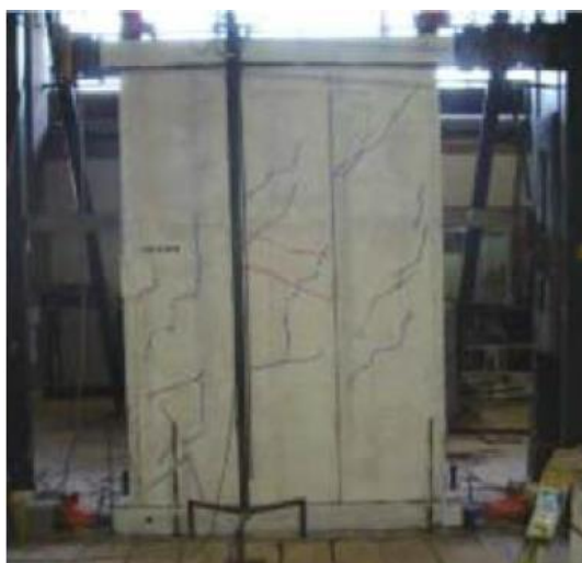
Figura 4.3: DICTUC. Ensayo de carga horizontal (corte) Fuente: (Carrasco, 2010).
