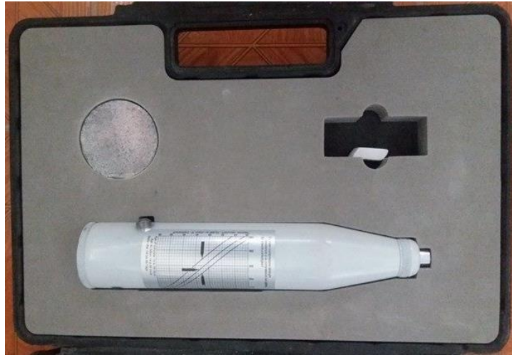
Fotografía 2.2: Equipo utilizado para el ensayo ASTM C 805/C 805M – 08.
