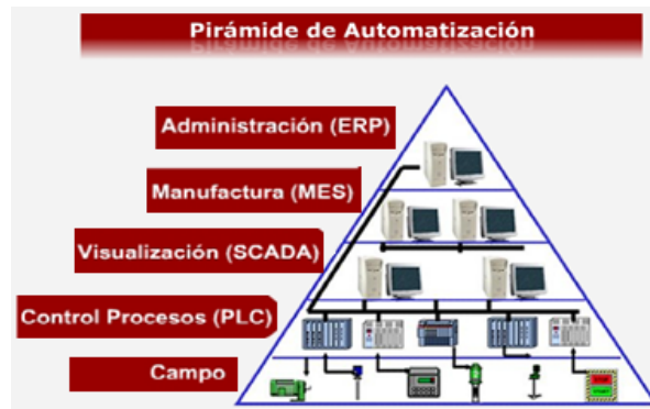
Fig. 2.53. Pirámide de automatización. [18]
