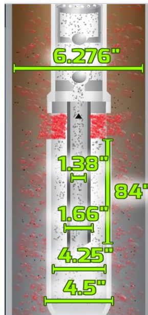
Figura 4.2 Dimensiones del separador de gas Fuente: Gas Separator Simulator Elaborado por: Juan Diego Chicaiza y Ana Tapia
