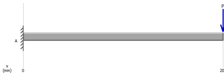
Figura 2.4 Modelo utilizado para el cálculo de esfuerzo en la cuchilla
