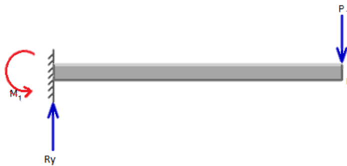
Figura 3.1 Diagrama de cuerpo libre de la cuchilla
