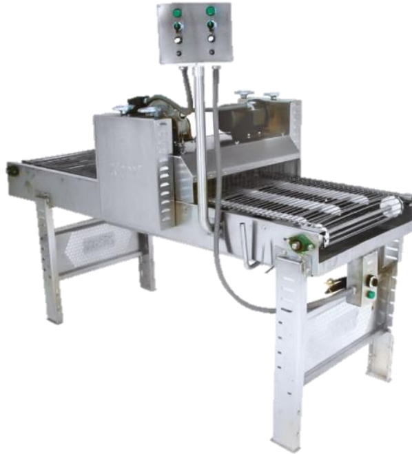
Figura 1.7 Desoperculadora automática horizontal de dos rodillos
