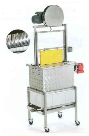
Figura 1.6 Máquina semiautomática para desopercular vertical de dos rodillos
