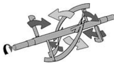
Figura 2.9 Mezclador de sólidos por cinta
