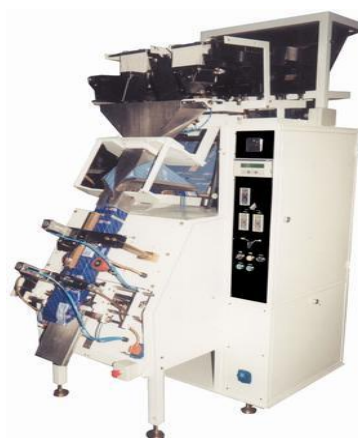
Figura 8 Envasadora vertical automática Modelo SENIOR EVS3 con dosificador Fuente: (INGESIR, s.f.)
