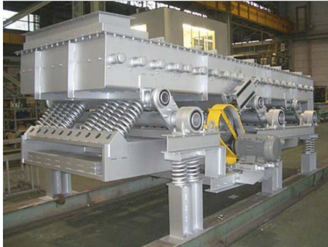
Figura 1.17 Transportador vibrante con accionamiento electromecánico
