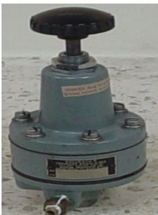
Ilustración 29 Regulador de Presión del equipo de Presión capilar Fuente: Registro Fotográfico del Equipo de Presión Capilar del Laboratorio de Petróleos de la Espol
