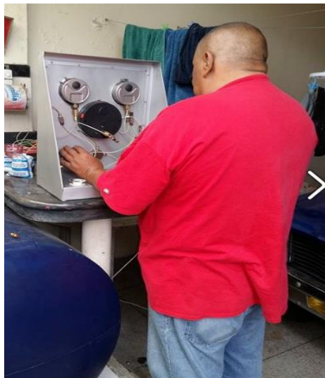
Ilustración 33 Inspección de ajuste de mangueras y válvulas por parte del Ing. Iván Fuente: Registro Fotográfico del Equipo de Presión Capilar del Laboratorio de Petróleos de la Espol
