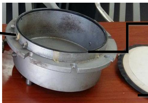
Ilustración 22 Componentes internos del plato poroso Fuente: Registro Fotográfico del Equipo de Presión Capilar del Laboratorio de Petróleos de la Espol
