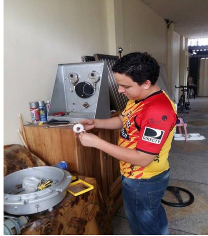
Ilustración 30 Estudiante Bryan Avilés adhiriendo teflón a la válvula de dos vías Fuente: Registro Fotográfico del Equipo de Presión Capilar del Laboratorio de Petróleos de la Espol
