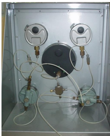
Ilustración 35 Caja Principal, parte posterior finalmente armada para su uso Fuente: Registro Fotográfico del Equipo de Presión Capilar del Laboratorio de Petr6leos de la Espol
