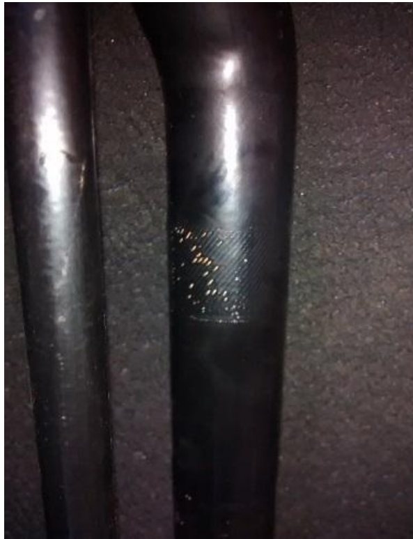
Figura 1-7 Porosidades en el recubrimiento del producto por mala limpieza
