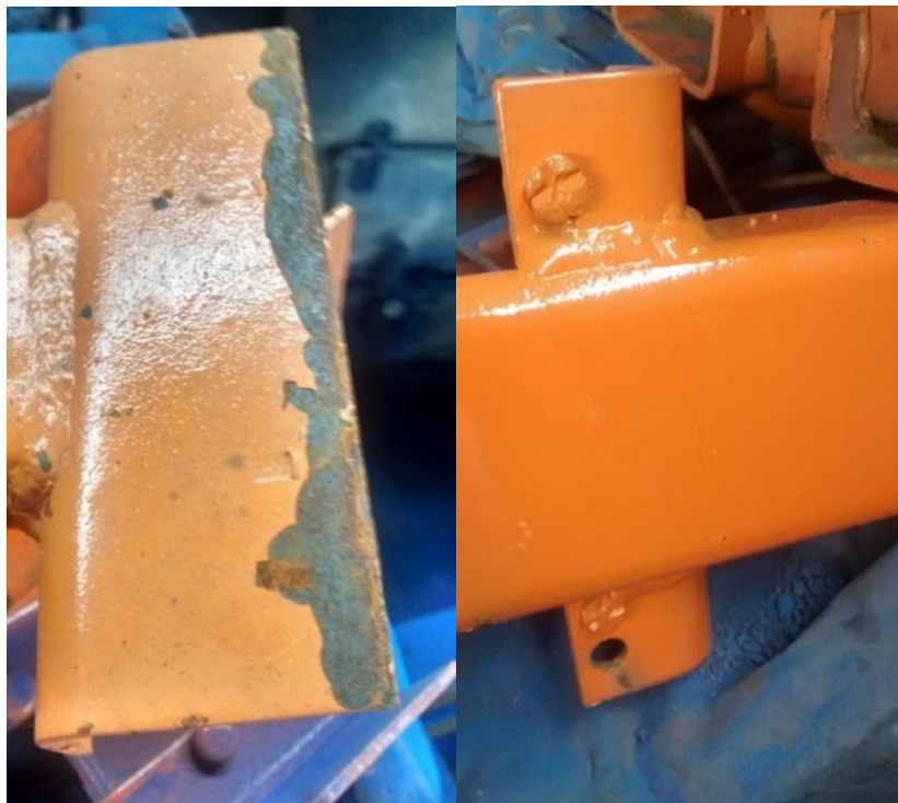
Figura 1-6 Falla por mala calidad de la pintura en el producto
