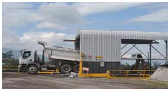
Figura N°11: Descarga en tolva de acumulación de trituradora primaria. (Crespo J, 2016)
