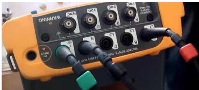
Figura 3.2: Analizador de Energía.
