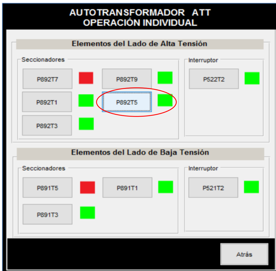
Figura 3.20 Estado final del elemento P892T5.
