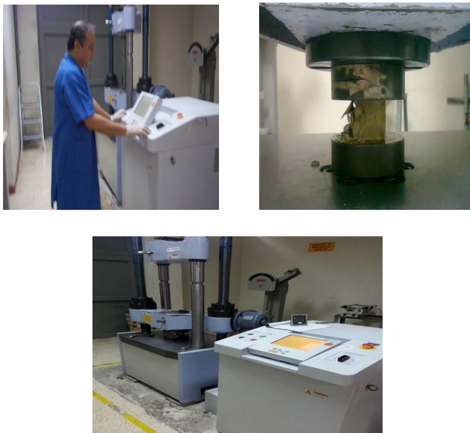
FIGURA 4.18. MÁQUINA DE ENSAYOS UNIVERSALES DE FUERZA DE COMPRESIÓN MODELO SHIMADZU UTM- 600KNI.
