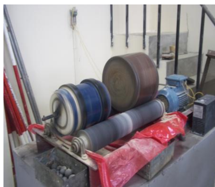
Figura 4.5. MOLINO DE BOLAS EN FUNCIONAMIENTO DE TAMBOR DE CERÁMICAS Y TAMBOR DE HIERRO FUNDIDO: TIEMPOS DE MOLIENDAS
