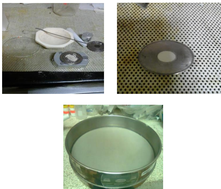
FIGURA 4.8. PREPARACIÓN DE MUESTRAS PARA ANÁLISIS CUANTITATIVO Y CUALITATIVO PARA DIFRACTOGRAMA DE RAYOS X
