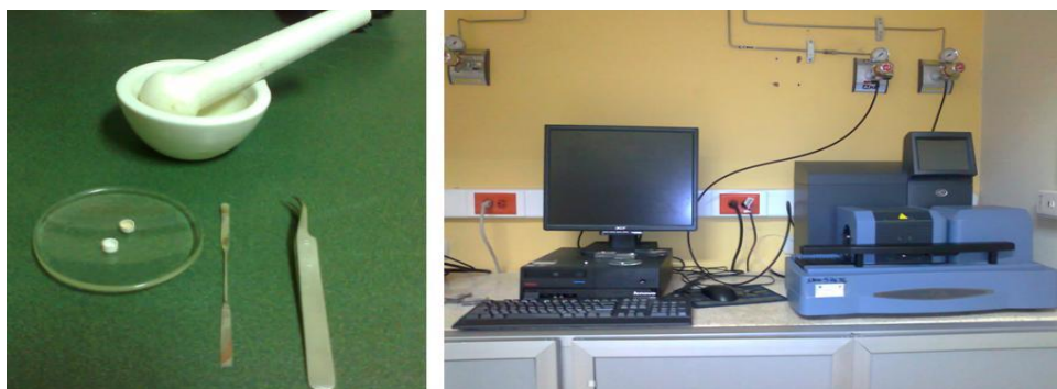
FIGURA 4.19. UTENSILIOS Y EQUIPO TGA-DSC PARA ANALISIS DE TERMOGRAVIMETRIA
