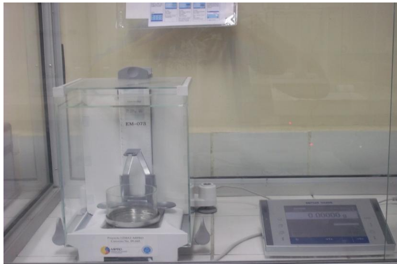
FIGURA 4.15. BALANZA ANALÍTICA DIGITAL PARA DETERMINAR LA DENSIDAD DE GEOPOLÍMEROS SÓLIDOS POROSOS.
