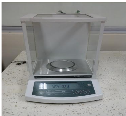
FIGURA 4.9. BALANZA DE PRECISIÓN METTLER TOLEDO MARCA SHIMADZU MODELO AX200
