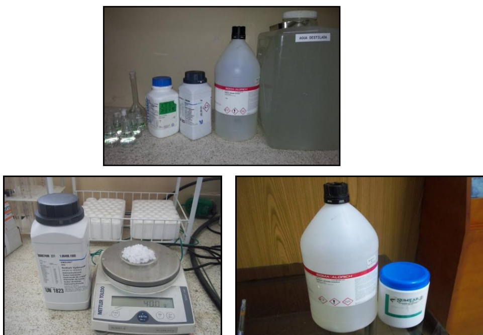
FIGURA 4.6. ACTIVAORES ALCALINOS Y MATRACES VOLUMÉTRICOS: HIDRÓXIDO DE SODIO, SILICATO DE SODIO E HIDRÓXIDO DE CALCIO.
