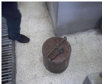
Figura 4.4. PREPARACIÓN DE TAMBOR DE HIERRO FUNDIDO CON BOLAS DE HIERRO Y TAMBOR DE CERÁMICA CON BOLAS DE ALUMINA.
