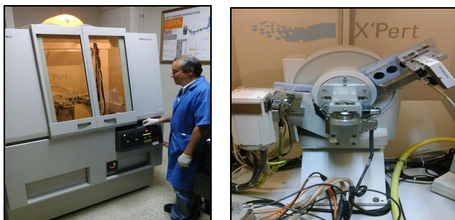
FIGURA 4.10. PROCEDIMIENTO DE COLOCACIÓN DE MUESTRAS Y ANÁLISIS CUANTITATIVO EN EL DIFRACTOGRAMA DE RAYOS X
