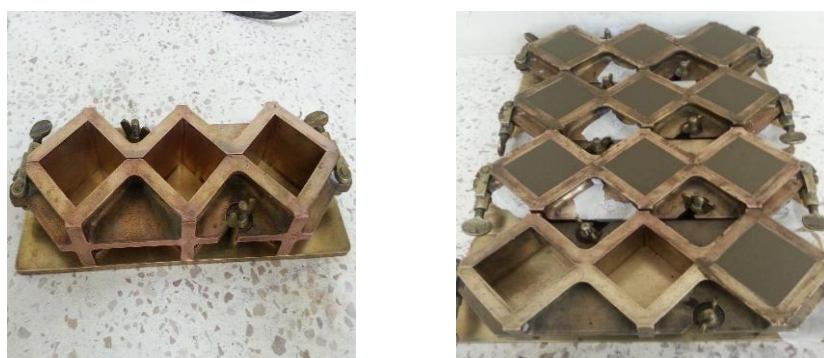
FIGURA 4.17. MOLDES UTILIZADOS DE ACUERDO A LA NORMA ASTM C109/C109 M-07.
