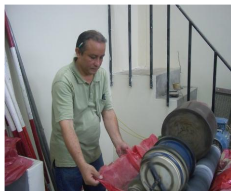
Figura 4.5. MOLINO DE BOLAS EN FUNCIONAMIENTO DE TAMBOR DE CERÁMICAS Y TAMBOR DE HIERRO FUNDIDO: TIEMPOS DE MOLIENDAS
