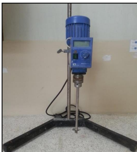
FIGURA 4.16. AGITADOR MECÁNICO IKALABORTECHNIK MODELO RW20DZMN
