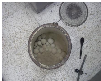
Figura 4.4. PREPARACIÓN DE TAMBOR DE HIERRO FUNDIDO CON BOLAS DE HIERRO Y TAMBOR DE CERÁMICA CON BOLAS DE ALUMINA.
