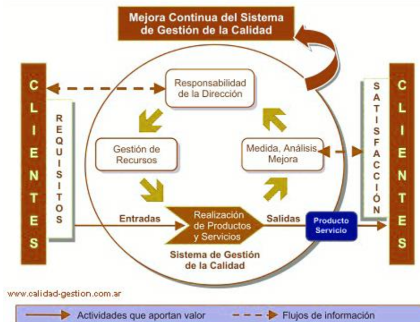
IMAGEN 1: "MODELO DE UN SISTEMA DE GESTIÓN DE LA CALIDAD BASADO EN PROCESOS"
