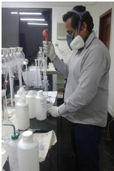
Preparación de soluciones y medición de conductividad
