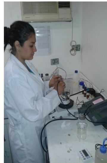
Preparación de soluciones y medición de conductividad
