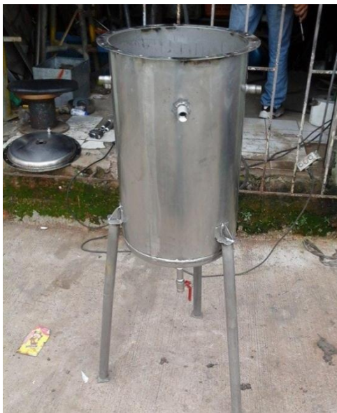
Tanque luego del proceso de Soldadura TIG
