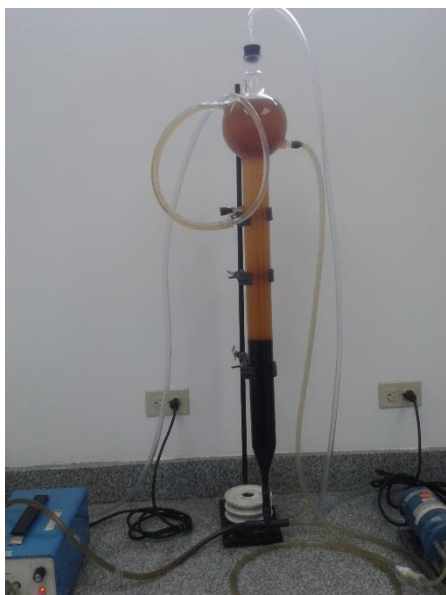
Figura 4.5.- Reactor UASB en funcionamiento. Fuente: Alcívar 2014
