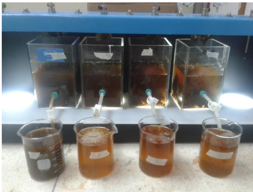
Figura 5.2.- Resultados del test de jarras. Fuente: Alcívar 2014
