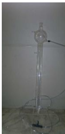
Figura 4.1.- Fotografía del reactor UASB. Fuente: Alcívar 2014
