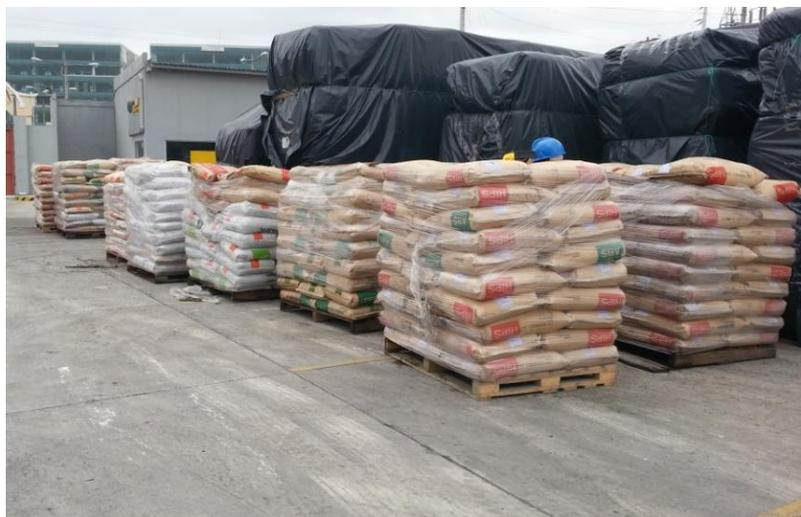
**Figura 3.1.:** Pallets con sacos de XPSd pelletizado
