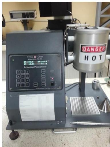
**Figura 3.7.:** Plástómetro, Laboratorio de plásticos,
