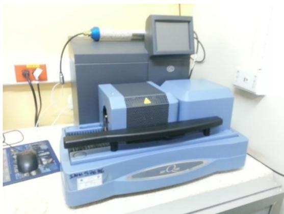
**Figura 3.9.:** Equipo de DSC/TGA o Calorímetro, LEMAT
