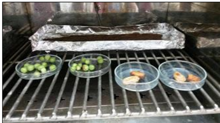
Figura A.2.2. Muestras en la estufa a 105°C
