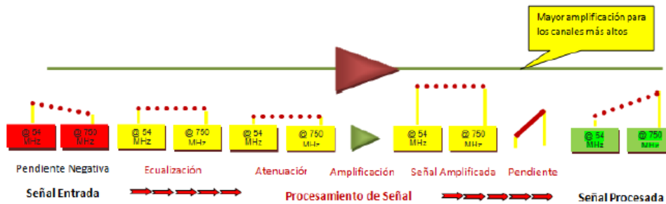
Figura 2.6: Comportamiento de la señal durante varias etapas del amplificador [14].
