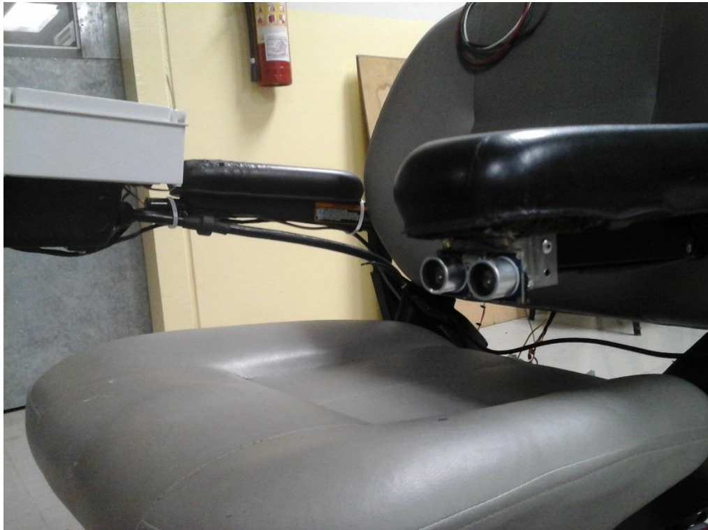
Figura 3.17. Sensor ultrasónico frontal bajo el apoyabrazo izquierdo
