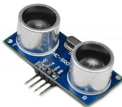
Figura 1.7: Sensor ultrasónico HC-SR04. 9
