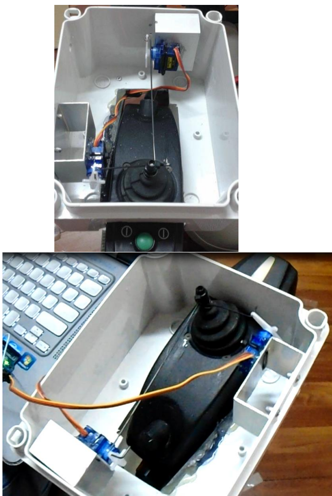
Figura 3.19. Prueba del servomecanismo, movimiento hacia la izquierda
