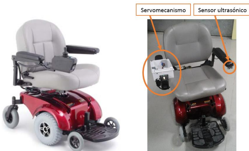
Figura 3.10: Vista frontal de la silla antes y después de instalar el nuevo sistema de control.
