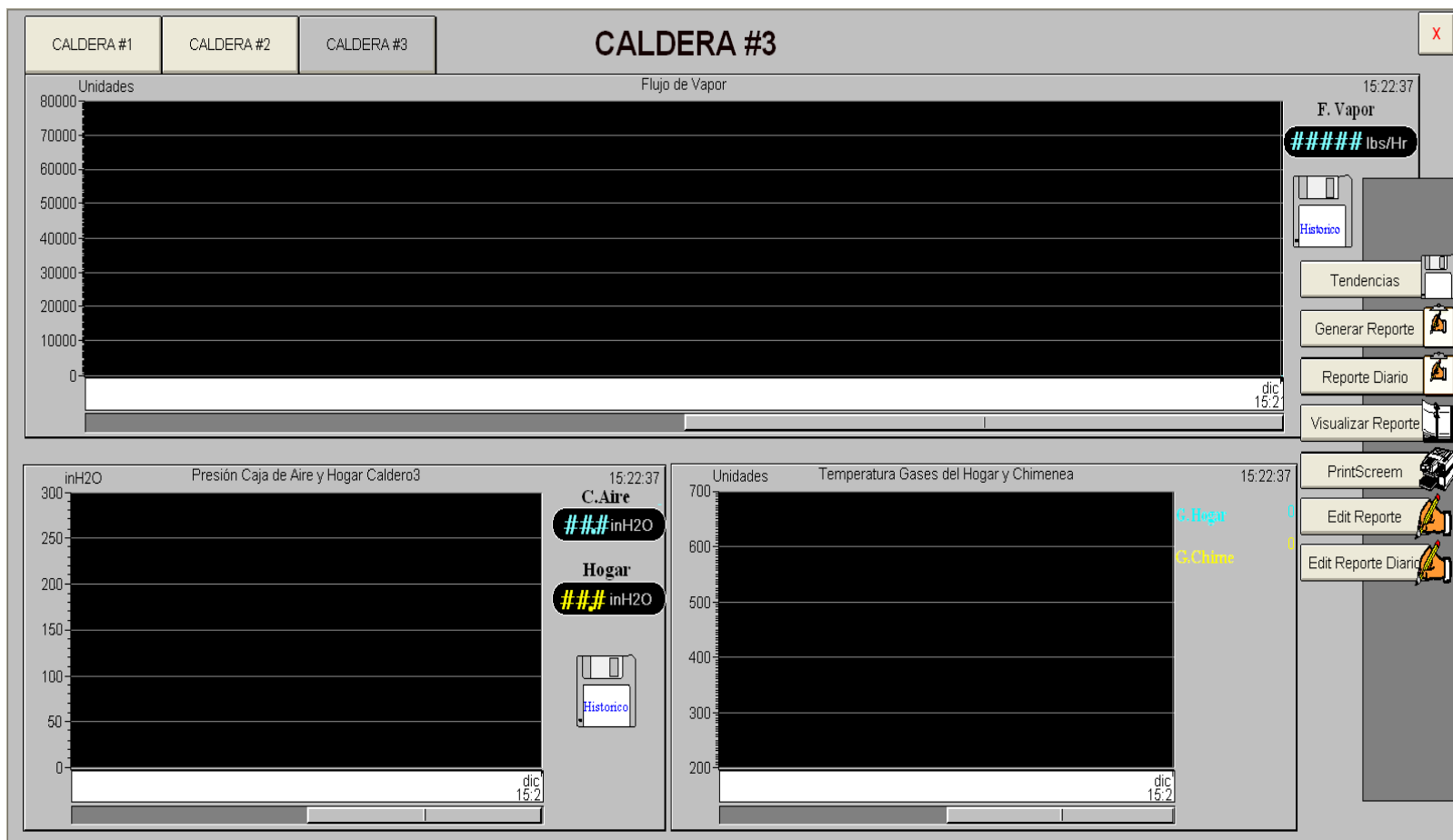
Figura 2.44: Pantalla en donde se visualiza la tendencia del consumo de flujo de vapor de la caldera.
