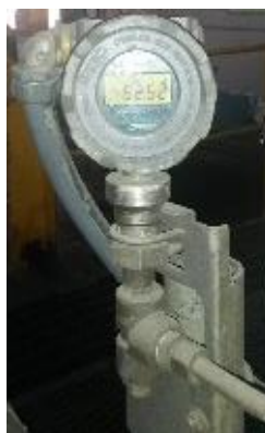
Figura 2.17: Transmisor de presión.
