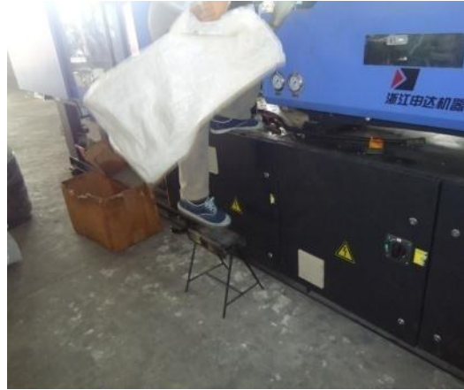
Escalera sin soporte seguro
