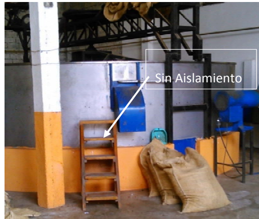
Figura 3-5, Pérdida de calor por las paredes del secador
