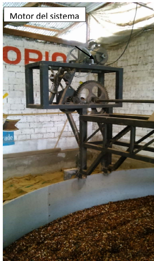
Figura 3-3, Motor que impulsa el sistema que mueve el grano de cacao
