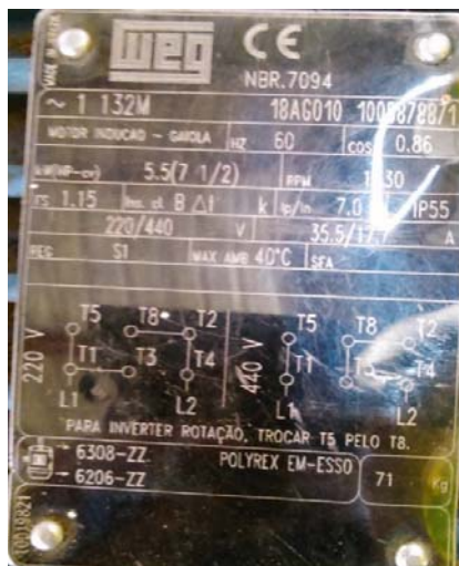
Figura 3-4, Placa y ubicación del motor del ventilador centrifugo
