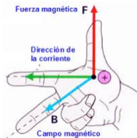
Figura 12: Regla de la mano derecha para obtener la dirección de la fuerza magnética sobre un hilo conductor recto en el que circula corriente eléctrica obtenido de http://angelicaperdomo123.wordpress.com/acerca-del-1er-corte/magnetismo/regla-o-ley-de-la-mano-derecha/
