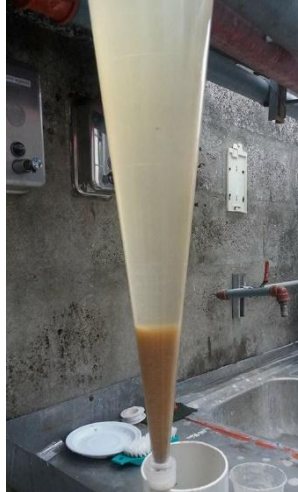
Figura 2.2. Control de lodos en el reactor en el cono Imhoff.
