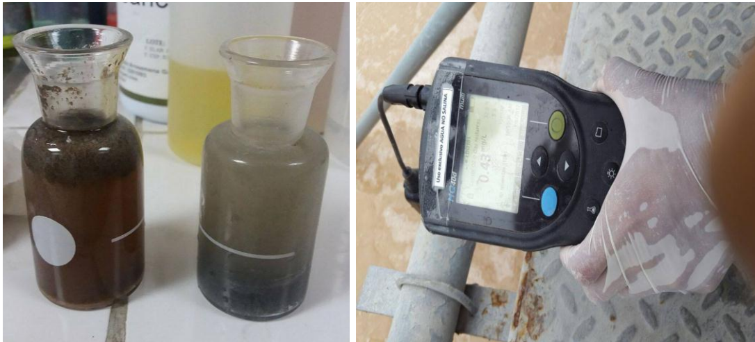
Figura 2.5. Medición de oxígeno disuelto con método Winkler modificado y multiparámetro.
