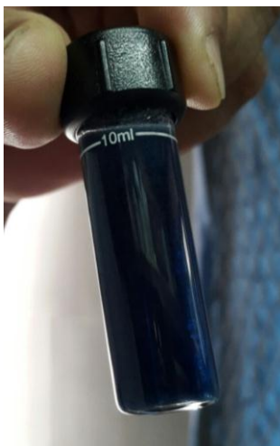
Figura 2.4. Determinación del contenido de fósforo en el agua residual.
