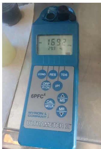
Figura 2.1. Medición de TDS con equipo Ultrameter II 6PFC.
