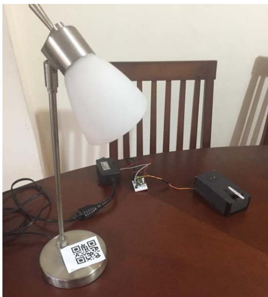
Figura 4.7. Dispositivo inteligente (Photon conectado a switch de poder, a una lámpara y un servo motor).
