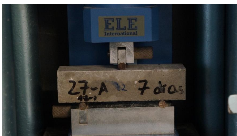
Figura 0.10 Ensayo a la flexión en vigas de 40x40x160 mm Fuente: Autores
