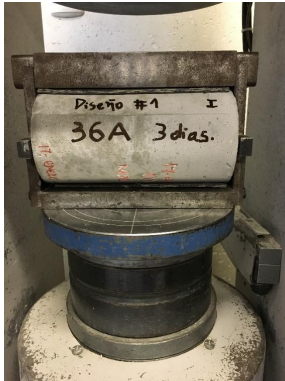
Figura 0.11 Ensayo a la compresión diametral en cilindros de 100x200 mm Fuente: Autores
