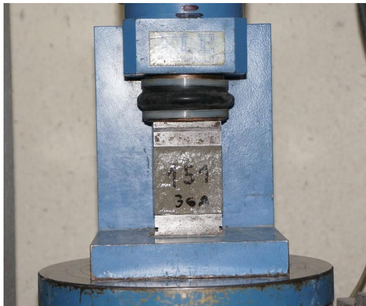
Figura 0.9 Ensayo a la compresión en cubos de 50x50 mm Fuente: Autores
