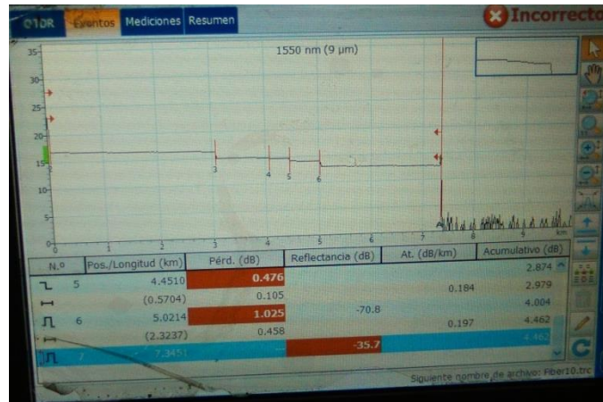
Figura 4.2 Medición de pérdidas
