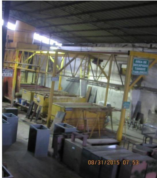
**Figura 1.3: Área de decapado y fosfatado**
