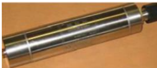
Figura 3. 16: Sensor de presión Digiquartz Paroscientific. [27]
