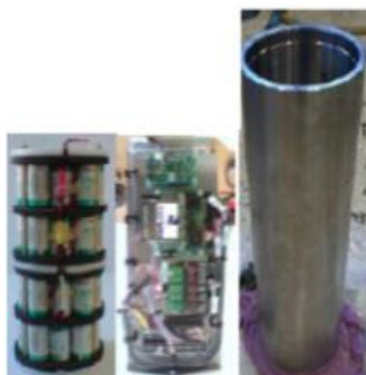
Figura 3. 20: Estructura de titanio para protección componentes electrónicos. [27]
