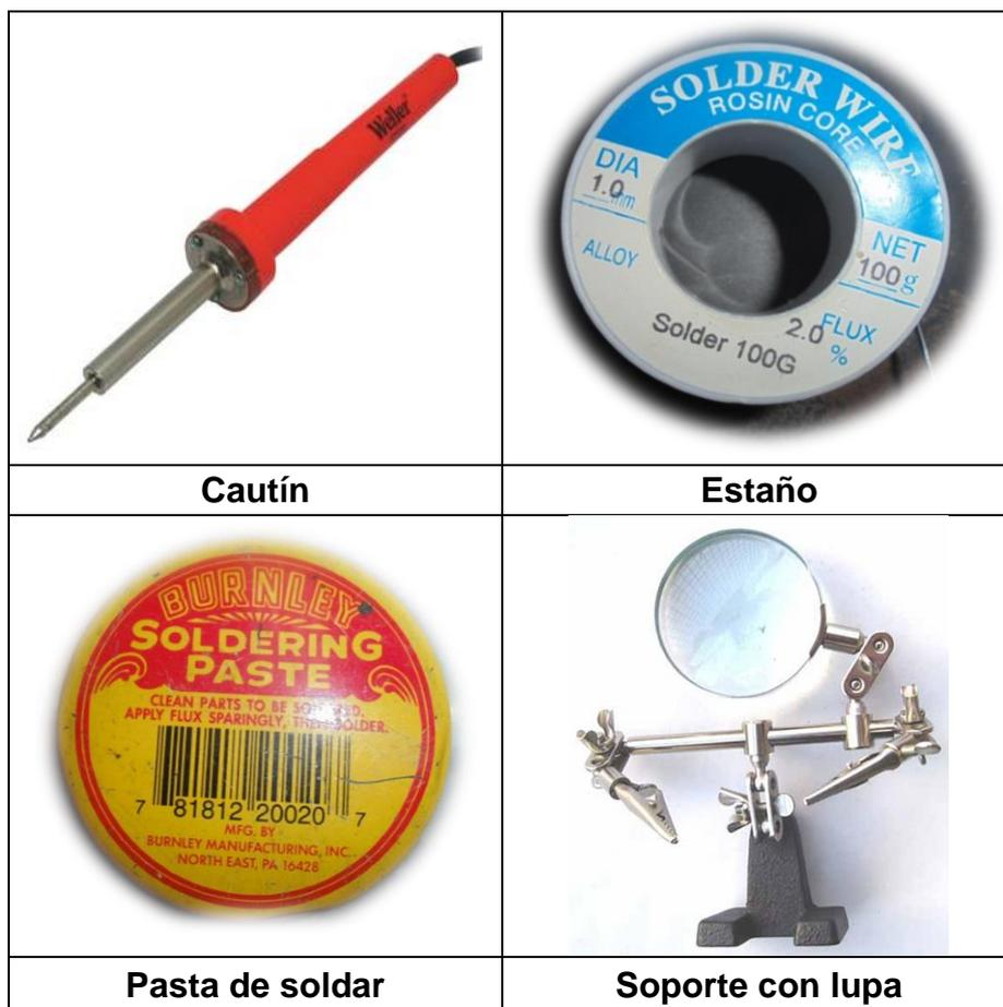
**Figura E 1:** Elementos utilizados en el proceso de soldadura de los extensómetros.
