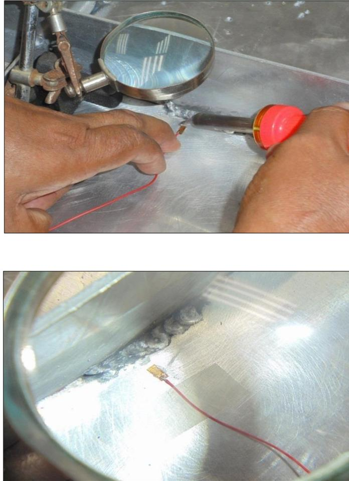
**Figura E 2:** Soldadura de los terminales de los extensómetros a los cables conductores.
