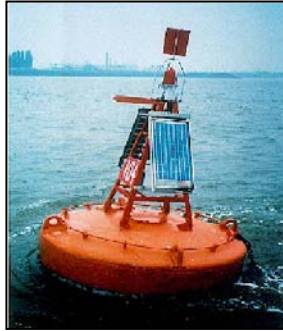
Figura 2.20 Sistema fotovoltaico en señalización marítima. 42
