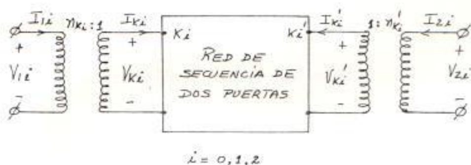
Fig 34. Representación de una red de dos puertas para fallas simultáneas en F y F'.
