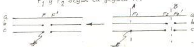
Fig 47. Determinación del modelo matemático para una falla de una línea a tierra y dos fases abiertas.
