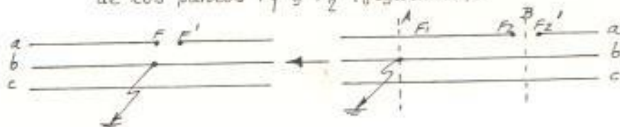
Fig 45. Determinación del modelo matemático para una falla monofásica a tierra más una fase abierta.
