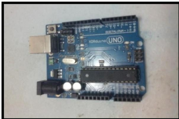
**Figura 2.9: Placa Arduino Uno**
