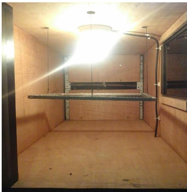
Vista Interior de la Secadora Tipo Túnel
