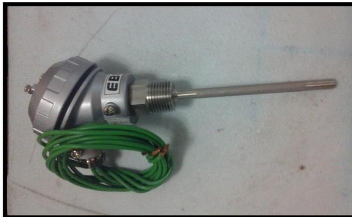
**Figura 2.6: Sensor de Temperatura**
