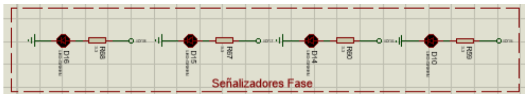
Figura 4.23: Activación de los señalizadores de fase.
