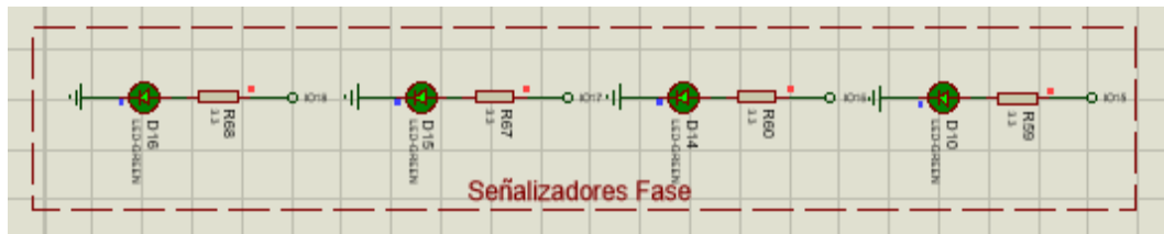
Figura 4.21: Activación de los señalizadores de fase.
