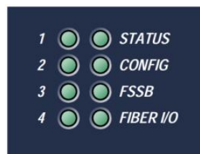
Figura2.23 Leds Indicadores del PACMotion
