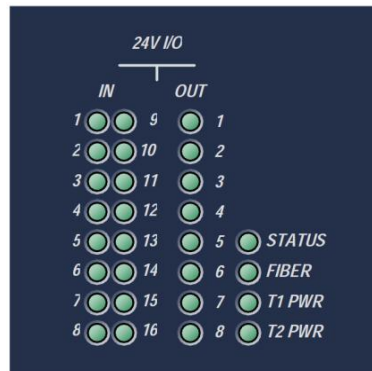
Figura 2.24 Leds Indicadores del FTB
