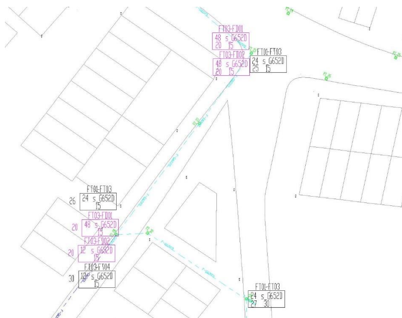
Figura 3.33: Imagen de las reserva del tramo de Barrio Latacunga.
