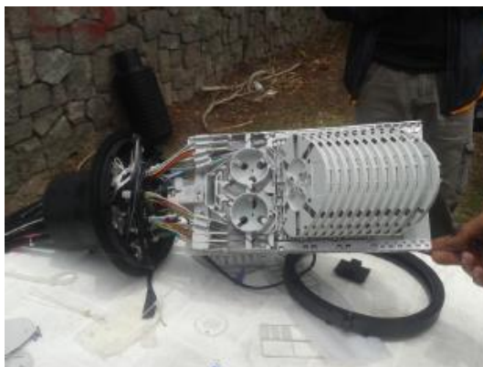
Figura 3.22: Foto del interior de una manga con sus respectivas bandejas. [26]
