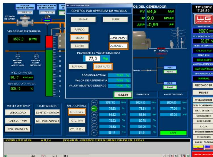
Fig. 2.10: Control por porcentaje de apertura de las válvulas reguladoras (VPC, PAV)
