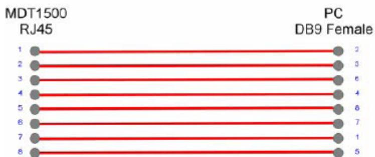
Figura 2.8: Cable conexión MDT1500 [3]
