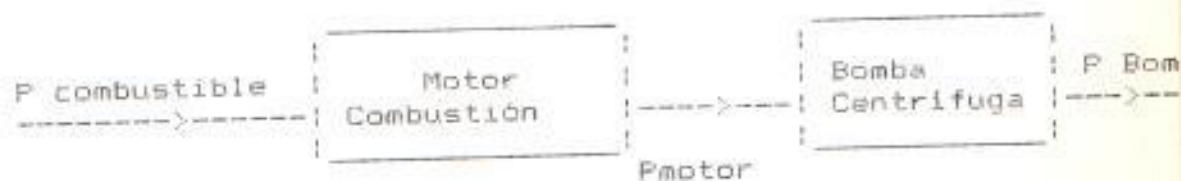
Fig. 3.3 Estación de bombeo, elementos principales
