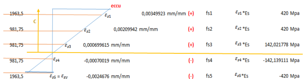
Figura 7.19. Distribución de esfuerzos en Punto C
