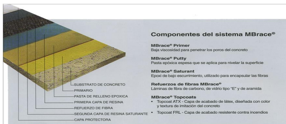
Figura 5.1. Componentes de un sistema FRP Fuente: (Master Builders. MBRACE, 1998).
