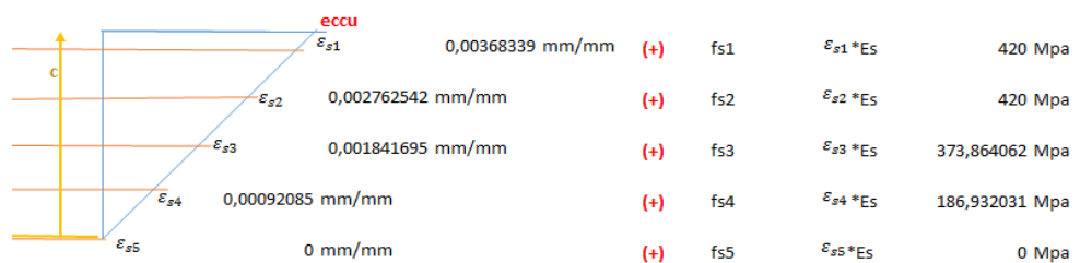
Figura 7.17. Distribución de esfuerzos en cada capa de acero longitudinal en Punto B.
