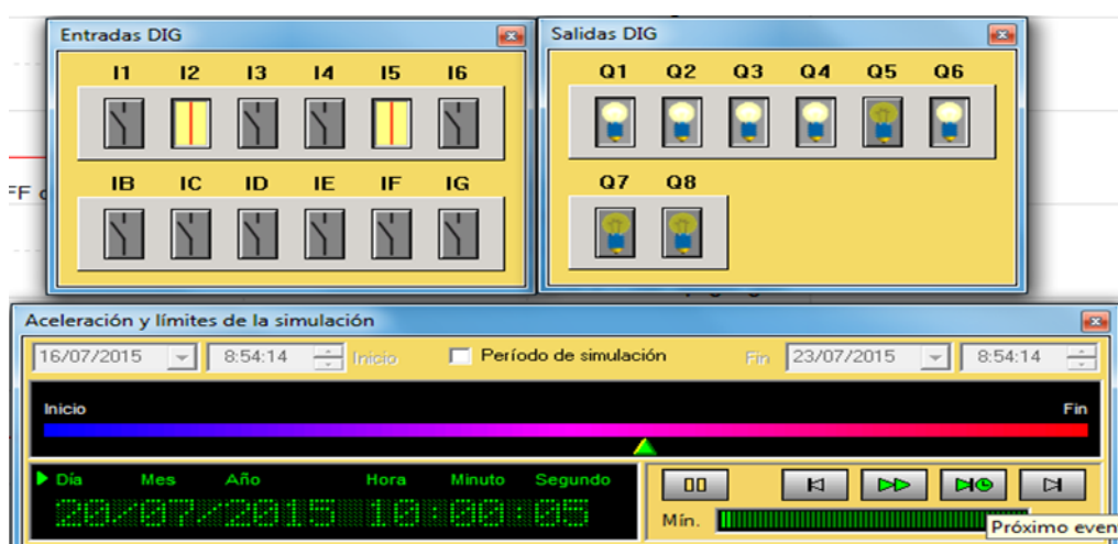
Figura 2.9: Bobina de mantenimiento activada los lunes 10:00 am.
