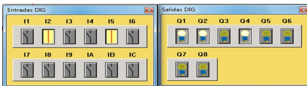
Figura 2.4: Retorno de red y transferencia Q5 desactivada.
