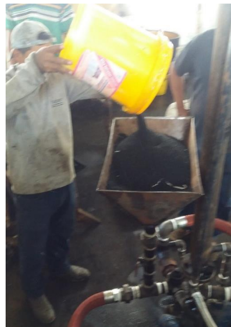
Figura 4.6. Ingreso del polvo de caucho conectado a la olla.
