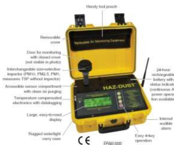
Figura 10. Equipo utilizado para la recolección de datos. EPAM 5000
