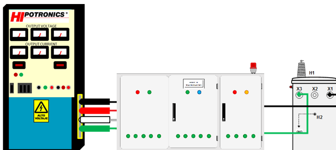
Figura 5.1. Prueba de vacío de transformador monofásico.
