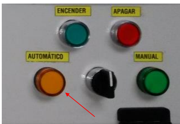
Figura 4.7. Posición del selector en modo automático.
