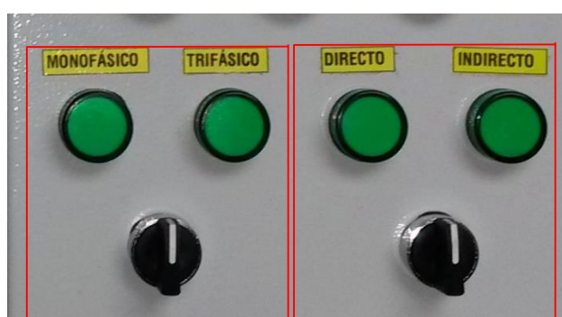
Figura 4.5 Selectores para modo de alimentación y conexión.
