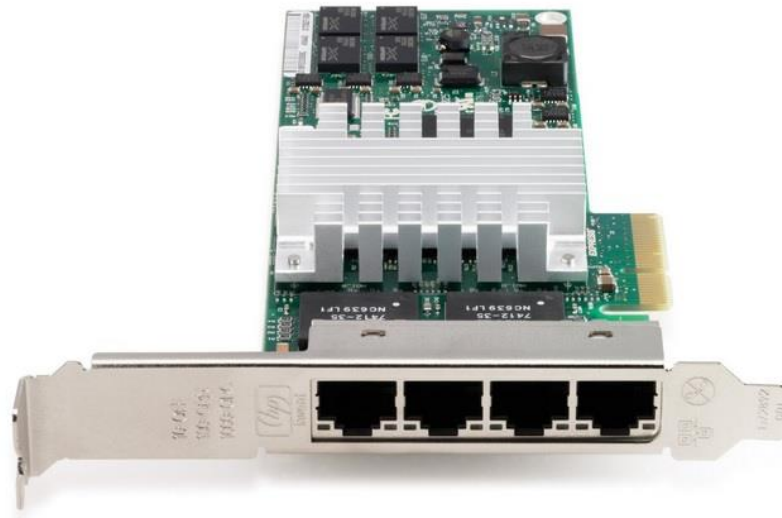
Figura 3.11.- Tarjeta de Red Multi-puerto HP NC364T PCI-e.
