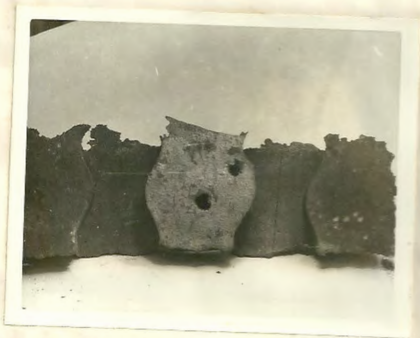
FOTOGRAFIA 3.9.- PIEZA FUNDIDA UTILIZANDO CORAZON ELABORADO CON ARENA LIMON 2.
