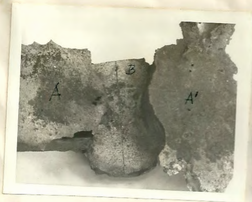
FOTOGRAFIA 3.8.- PIEZA FUNDIDA UTILIZANDO CORAZON ELABORADO CON ARENA LIMON 1.
