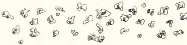
FIG. 2.3.- ARENA DE GRANOS SUB-ANGULARES
