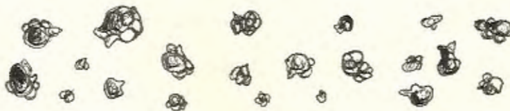
FIG. 2.5.- ARENA DE GRANOS COMPUESTOS
